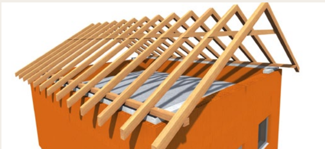
1. Krokve připravené na montáž bednění
