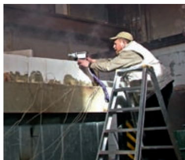
Test střechy s nehořlavou izolací Rockwool. (obr. 26)
