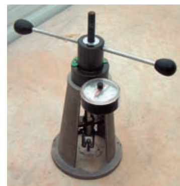
Výtažná zkouška kotevního prvku mechanické kotvy (obr. 49)
