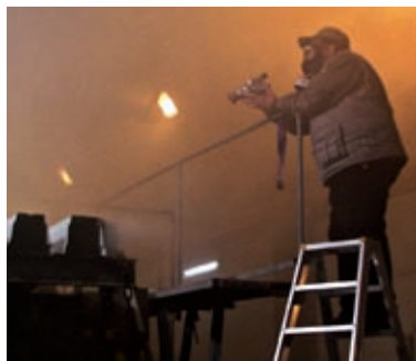
Test střechy s izolací PIR. Intenzivní vývin kouře trval až do vzplanutí izolačních desek. (obr. 25)
