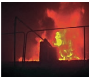
Náhlé vzplanutí celého povrchu vzorku střechy s izolací z EPS po 10 minutách testu. (obr. 23)
